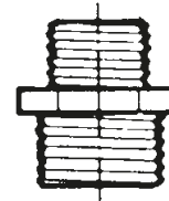
Штуцер редукционный с внешней резьбой.
